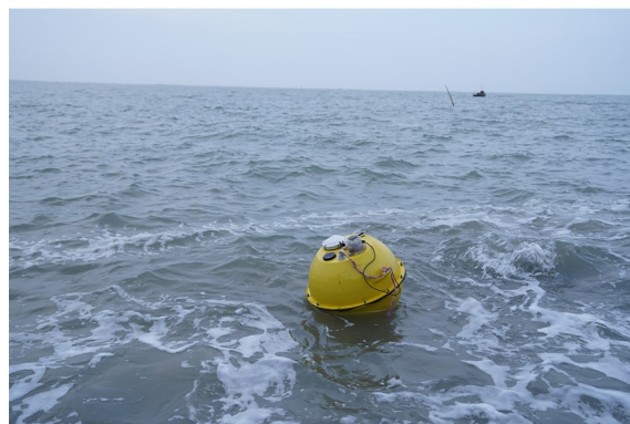
图3 南京信息工程大学研制的海洋波浪浮标 [14]
